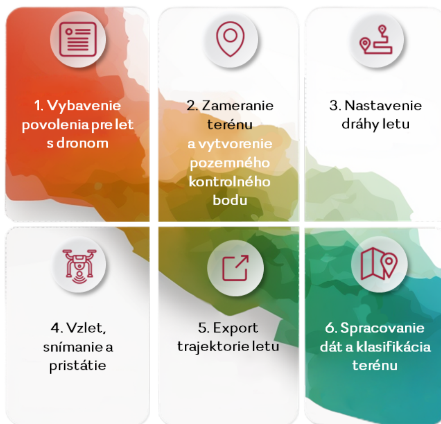
Obrázok 20: Proces vytvorenia 3D mračna bodov
